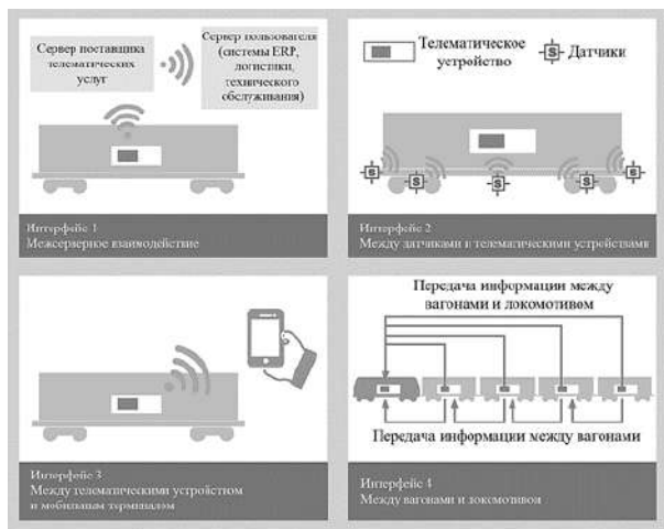
Рисунок 1 – Интерфейсы в комплексе телематического оборудования
