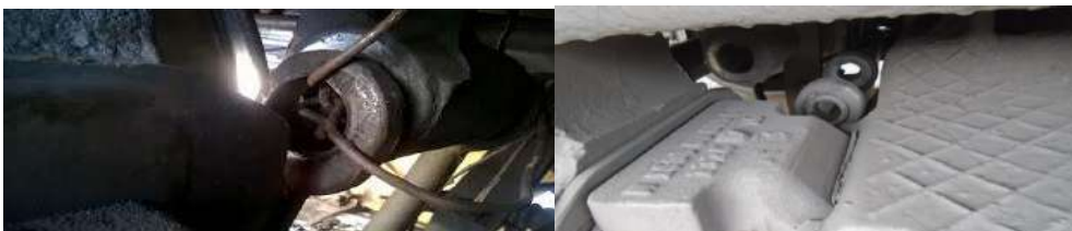
Рисунок 2 – Отсутствие резиновой и волокнистой втулки
