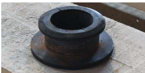
Рисунок 4 – Резиновая и полиуретановая втулки подвески тормозного башмака
