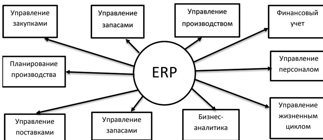
Рисунок 2 – Блок-схема модулей ERP системы
