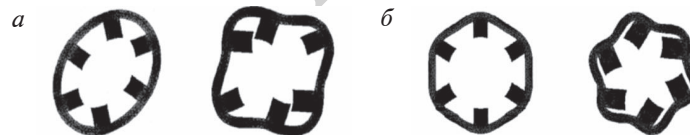
Рис. 1.59. Деформация статора при резонансе по второй ( а ) и третьей ( б ) резонансной частоте
