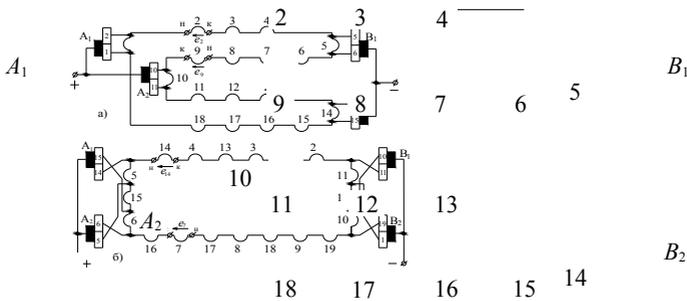
Рисунок 2.10 – Схема параллельных ветвей простой двухслойной петлевой обмотки, изображенной на рисунке 2.9
