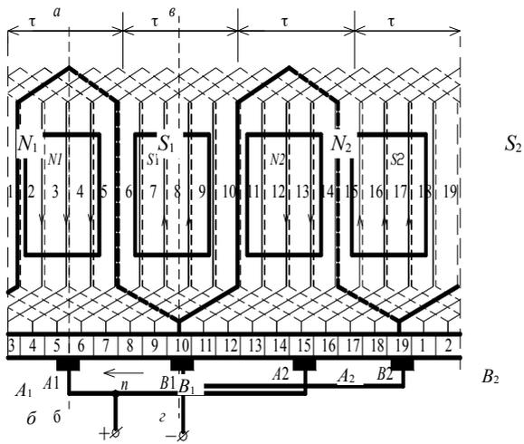
Рисунок 2.13 – Схема-развертка простой двухслойной волновой обмотки при  $Z_{3л} = S = K = 19$ ;  $p = 2$ ;  $y_1 = 4$ ;  $y_k = 9$
