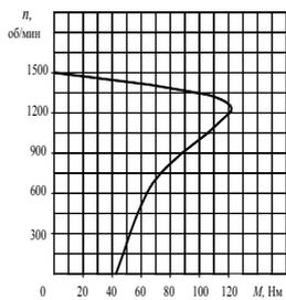
Рисунок 2.7 – Расчётная зависимость частоты вращения двигателя от вращающего момента
