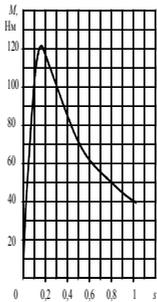
Рисунок 2.6 – Расчётная зависимость вращающего момента двигателя от скольжения
