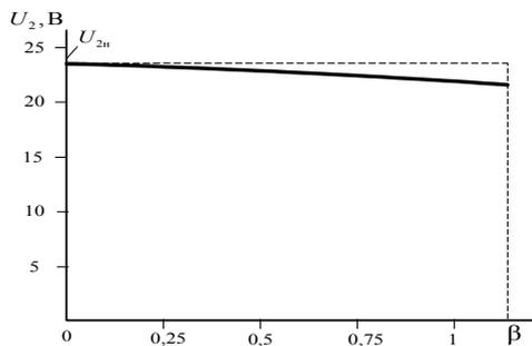
Рисунок 2.3 – Внешняя характеристика однофазного трансформатора
