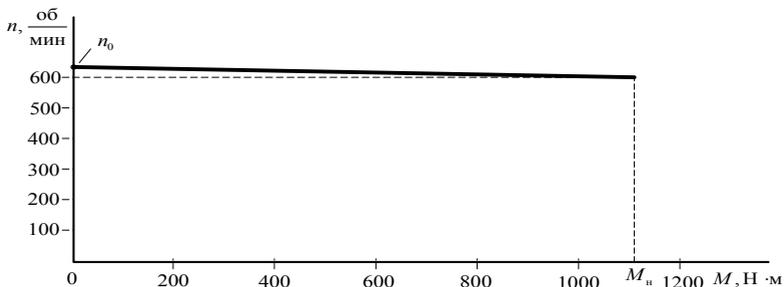
Рисунок 2.16 – Механическая естественная характеристика  $n = f(M)$
