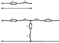
Рисунок 2.4 – Схема замещения одной фазы трёхфазного трансформатора
