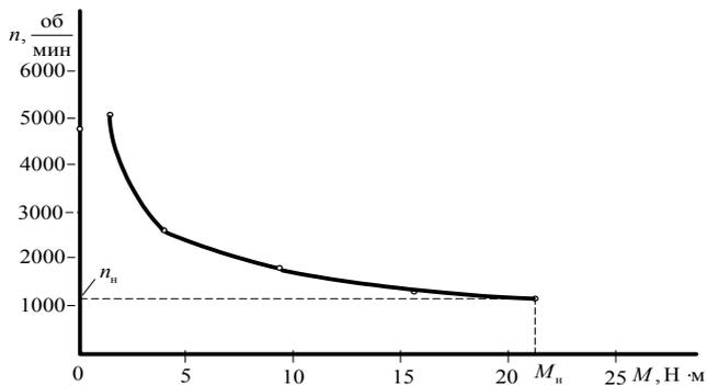
Рисунок 2.19 – Механическая характеристика  $n = f(M)$
