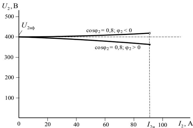
Рисунок 2.5 – Внешние характеристики при различных характерах нагрузки
