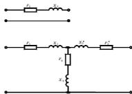
Рисунок 2.1 – Т-образная схема замещения однофазного трансформатора
