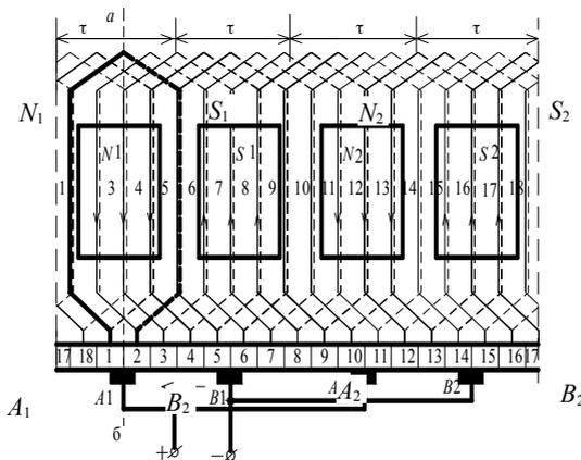
Рисунок 2.9 – Схема-развертка простой двухслойной петлевой обмотки при  $Z_{эл} = S = K = 18; p = 2; y_1 = 4; y_K = 1$
