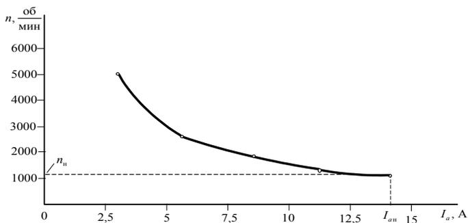
Рисунок 2.20 – Зависимость  $n = f(I_a)$
