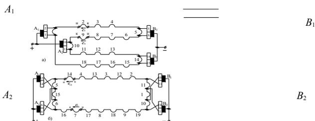
Рисунок 2.14 – Схема параллельных ветвей простой двухслойной волновой обмотки, соответствующая рисунку 1.19
