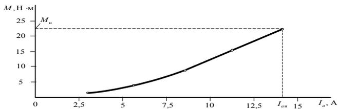
Рисунок 2.21 – Зависимость  $M = f(I_a)$
