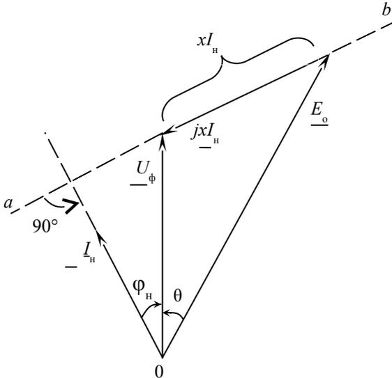
Рисунок 2.22 – Векторная диаграмма синхронного двигателя
