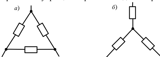
Рисунок 2.8 – Схемы соединения резисторов треугольником (а) и звездой (б)
