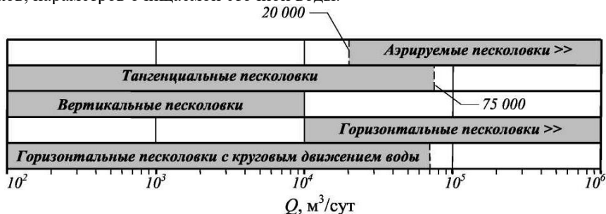
Рисунок 2.7 – Область применения различных типов песколовков в зависимости от производительности очистных сооружений
