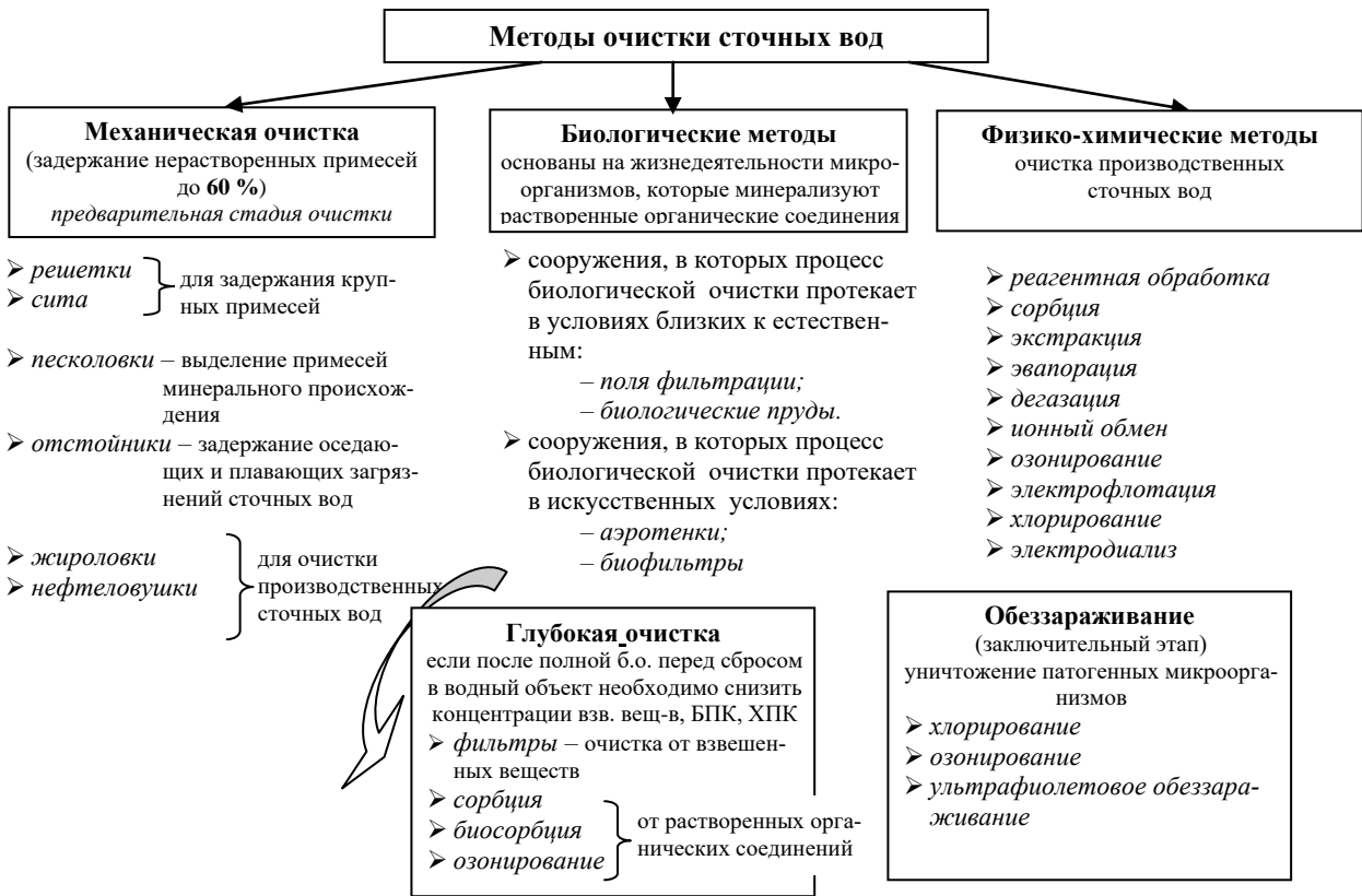
Рисунок 1.2 – Методы очистки сточных вод
