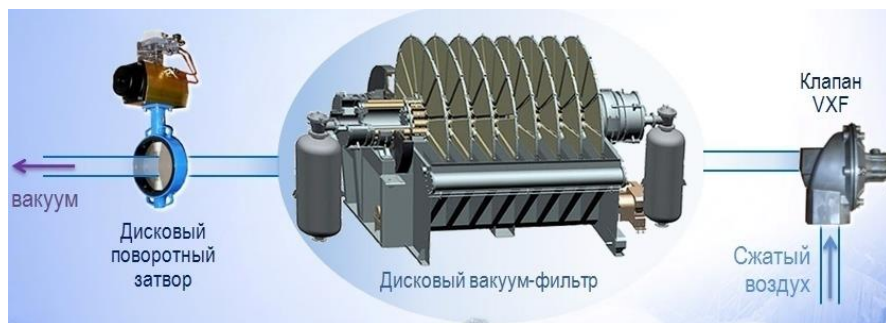
Рисунок 6.20 – Схема дискового вакуум-фильтра
