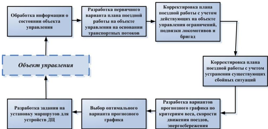
Рисунок 7.4 – Схема цикла формирования управленческих решений комплексной системы управления поездной работой дороги
