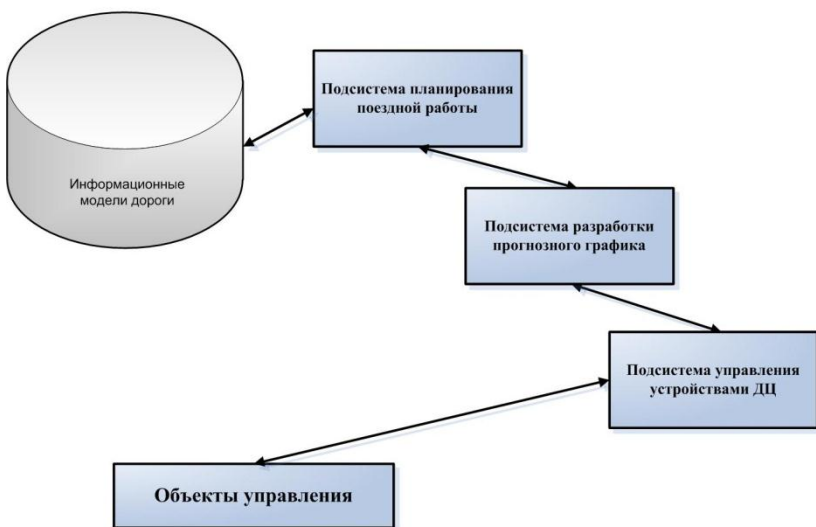
Рисунок 7.2 – Схема взаимодействия элементов комплексной системы планирования и управления поездной работой
