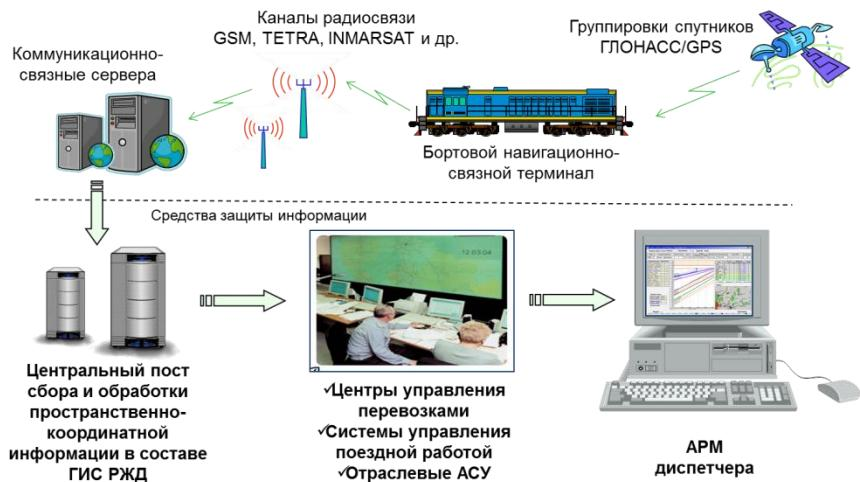
Рисунок 12.3 – Упрощенная схема определения местоположения подвижных объектов
