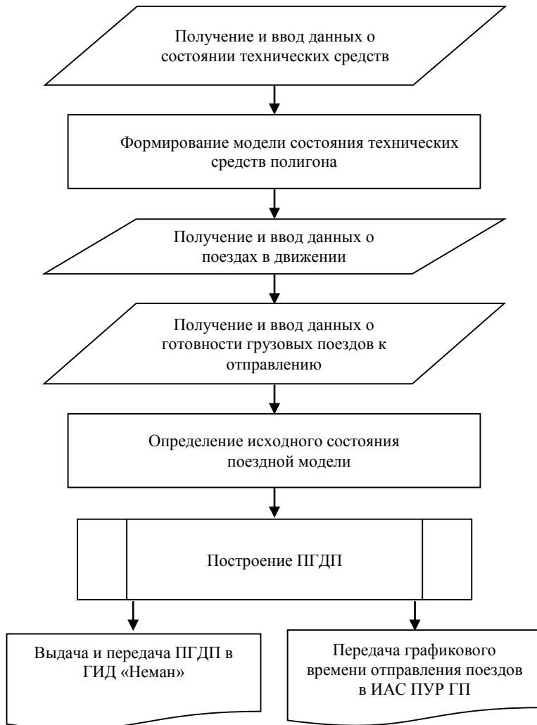
Рисунок 9.8 – Укрупненная схема разработки ПГДП
