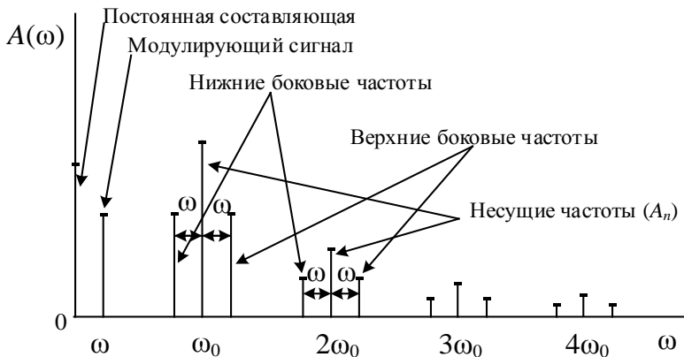
Рисунок 5 – Спектральная диаграмма АИМ сигнала при синусоидальном модулирующем сигнале
