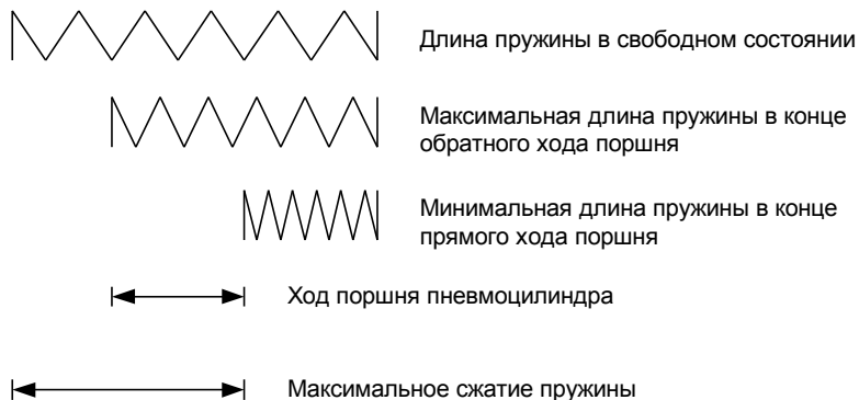
Рисунок 4 – Размеры возвращающей пружины при различных положениях поршня пневмоцилиндра
