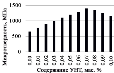
Рисунок 2 – Зависимость микротвердости металлополимерных нанонаполненных композиционных материалов, сформированных из порошковых систем «медь–УНТ–омедненный ПТФЭ (6 мас.%)», от содержания УНТ
