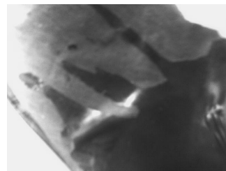
Рисунок 2 – Слоистая структура образца с содержанием нефти 20 мас. %
