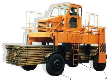
1, 3 – управляемые и ведущие ходовые колеса; 2 – грузозахватное устройство
