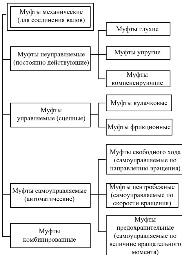
Рисунок 1.43 – Классификация механических муфт
