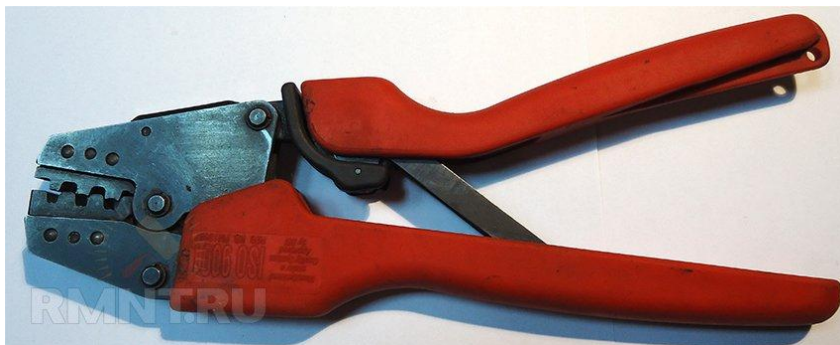
Рисунок 3 – Пресс для опрессовывания многопроволочных проводов сечением от 0,5 до 6 мм 2 ( https://rmnt.ru )
