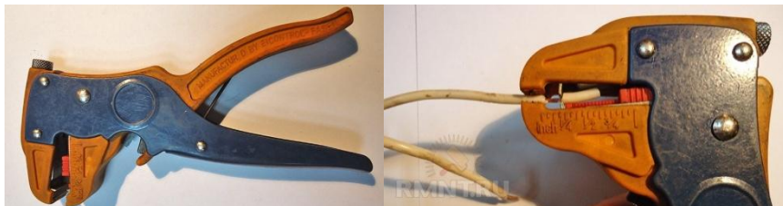
Рисунок 1 – Применение стрипперов для зачистки проводов ( https://rmnt.ru )
