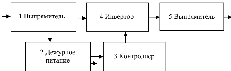
Рисунок 8 – Блок-схема импульсного блока питания компьютера
