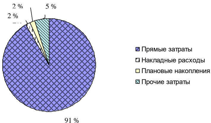
Рисунок 2.1 – Структура сметной стоимости строительства объекта
