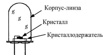
Рисунок 1.23 – Типовая конструкция светоизлучающего диода
