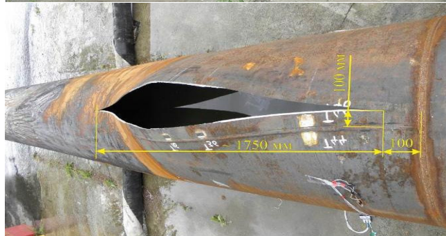
Рисунок 5 – Характер разрушения трубной плети
