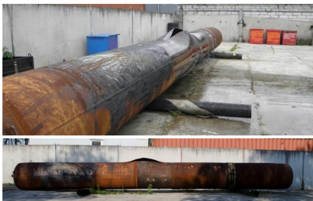
Рисунок 4 – Разрушенная трубная плеть после испытаний
