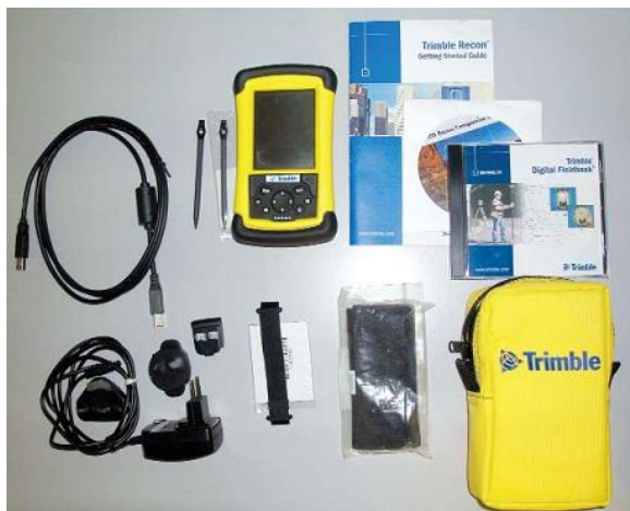
Рисунок 14.5 – Интегрированная одночастотная GPS-система определения координат на местности. Trimble R3 в сборе
