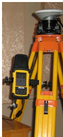
Рисунок 14.5 – Интегрированная одночастотная GPS-система определения координат на местности. Trimble R3 в сборе
