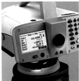
Рисунок 14.2 – Цифровой нивелир и штрихкодвая рейка
