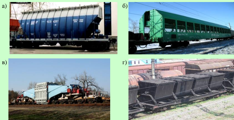
Рисунок 3.54 – Вагоны специального назначения: а – минераловозы; б – для перевозки автомобилей; в – транспортеры; г – для перевозки битума
