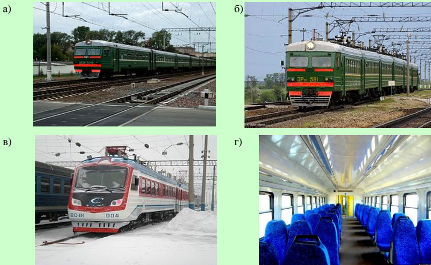
Рисунок 3.41 – Электропоезда, сформированные из секций: a – постоянного тока (ЭР-2); б – переменного тока (ЭР-9); в – постоянного тока 5-вагонная секция; г – салон электропоезда
