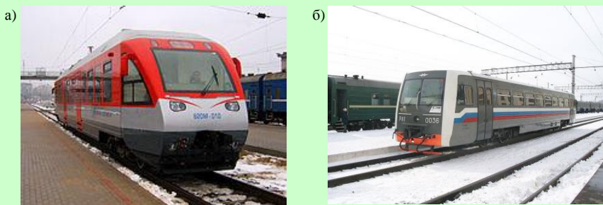
Рисунок 3.47 – Автономные рельсовые пассажирские транспортные средства: а – автомотриса; б – рельсовый автобус
