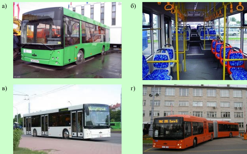
Рисунок 3.86 – Типы городских автобусов: а, б – малой вместимости (20 мест); в – средней; г – повышенной вместимости
