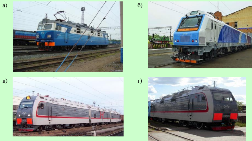
Рисунок 3.32 – Магистральные грузовые электровозы переменного тока: а – шестисный односекционный; б – восьмисный двухсекционный повышенной мощности; в – двенадцатисный трехсекционный; г – четырехосый односекционный малой мощности
