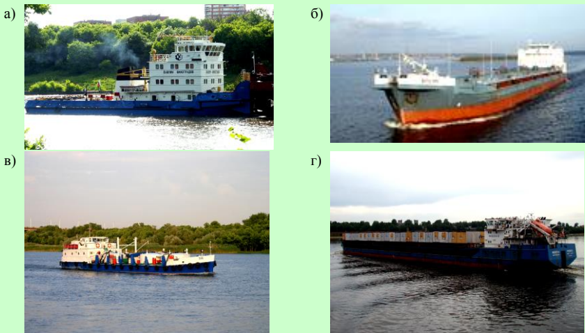
Рисунок 3.66 – Речной подвижной состав для грузовых перевозок: а – буксир; б – сухогруз; в – танкер; г – контейнеровоз
