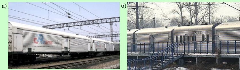
Рисунок 3.53 – Рефрижераторные вагоны: а – универсальный; б – 5-вагонная секция
