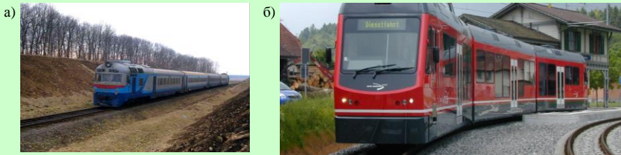
Рисунок 3.45 – Дизель-поезда модульного типа: а – с головными моторвагонами; б – со всеми моторвагонами
