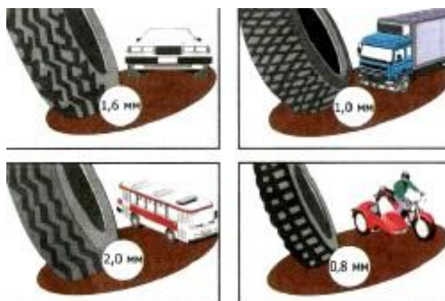
Рисунок Е.6 – Минимальные значения остаточной высоты рисунка протектора
