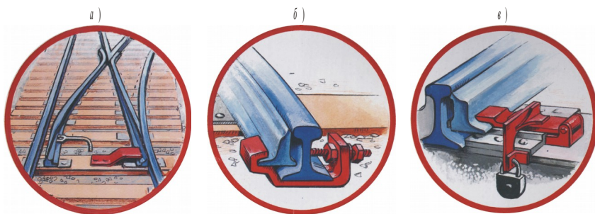
Рисунок Ж.1 – Устройства для закрепления стрелок, ведущих к месту работ: а – крепление остряка упоркой; б – крепление остряка скобой; в – запираение стрелки висячим замком
