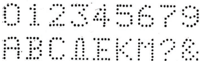
Рис. 95. Изображения знаков на основе матричного индикатора
