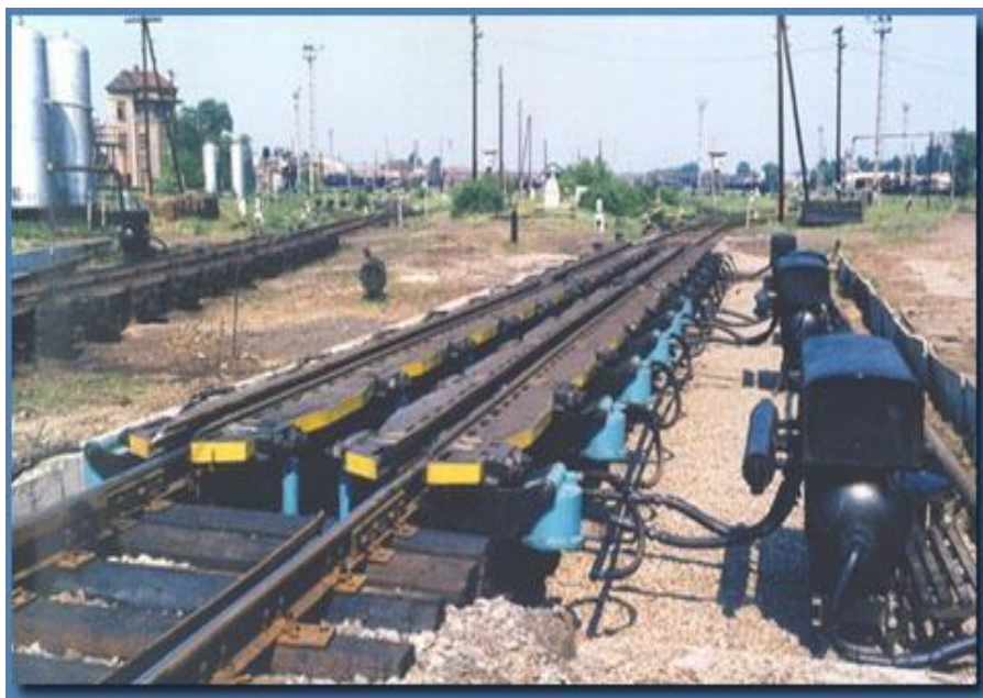
Рисунок 6 – Вагонный замедлитель НК-114
