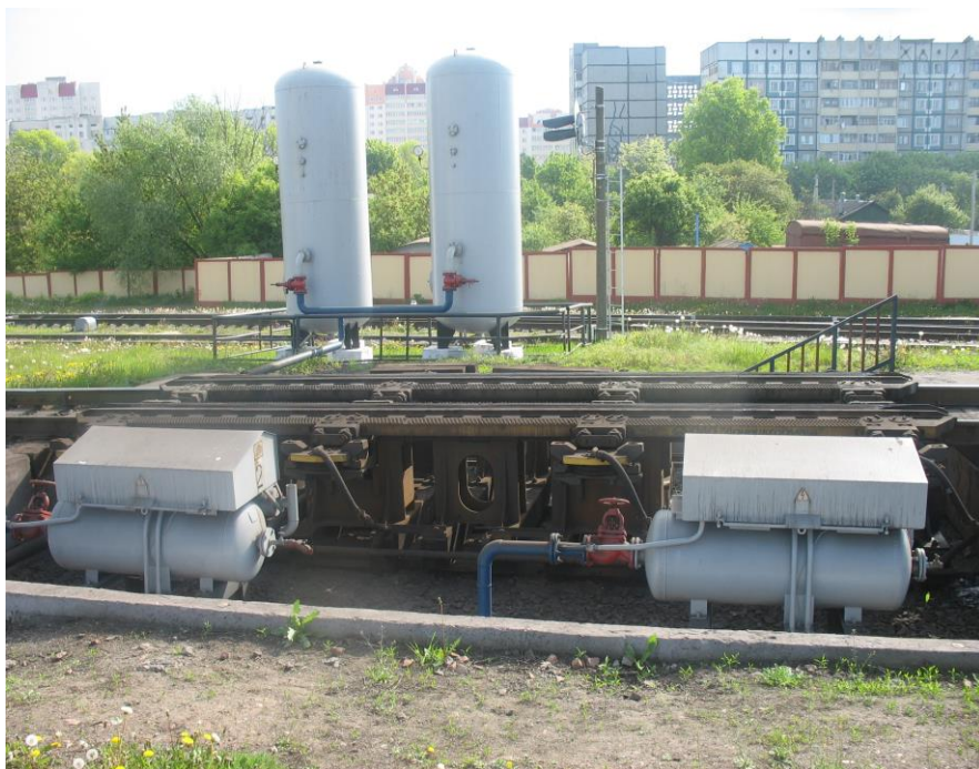
Рисунок 12 – Вагонный замедлитель ЗВУ с аппаратурой управления
