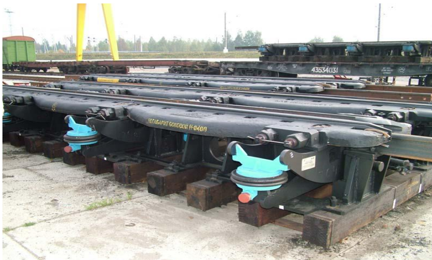
Рисунок 7 – Вагонный замедлитель КЗ-5ПК 2.3 ГВЗ типа ЗВУ
