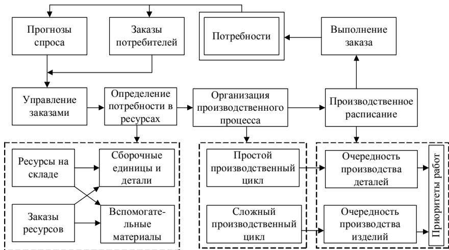
Рисунок 8.6 – Процесс функционирования MRP–систем на промышленном предприятии
