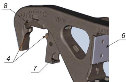
Рисунок 4.71 – Боковая рама с установленными износостойкой скобой и фрикционной планкой
