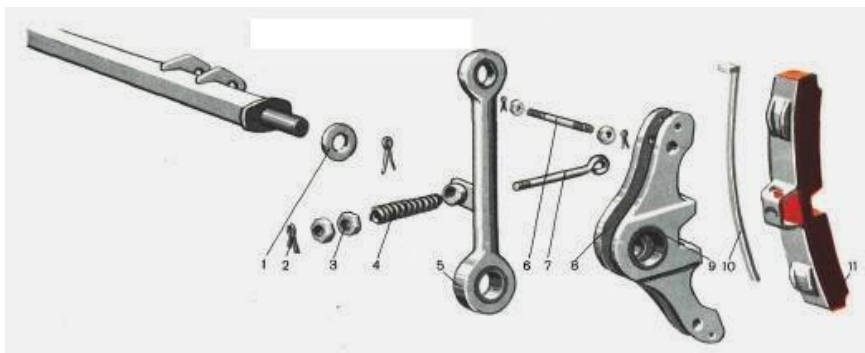
Рисунок 4.152 – Основные части тормозной рычажной передачи тележки: 1 – шайба; 2 – шпильки; 3 – гайки; 4 – пружина с колпачком; 5 – подвеска башмака; 6 – палец поводка; 7 – поводок; 8 – поворотный башмак; 9 – втулки; 10 – чека; 11 – тормозная колодка
