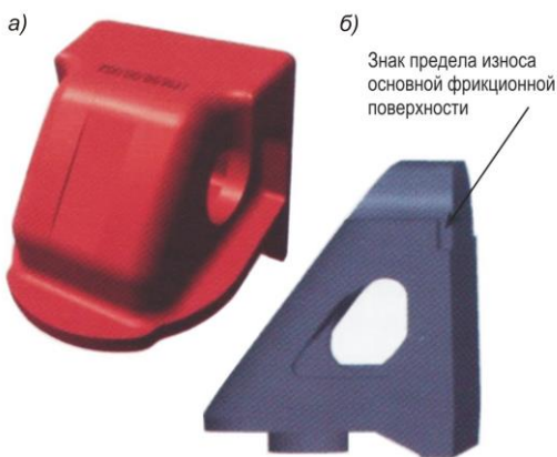
Рисунок 4.130 – Фрикционный клин: а – тележки модели 18-100; б – тележки 18-9996
