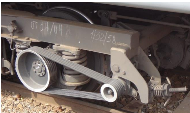
Рисунок 4.154 – Тележка модели 68-876 с приводом от торца оси
