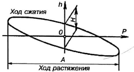
Рисунок 3.27 – Индикаторная диаграмма работы сил сопротивления гидравлического гасителя колебаний
