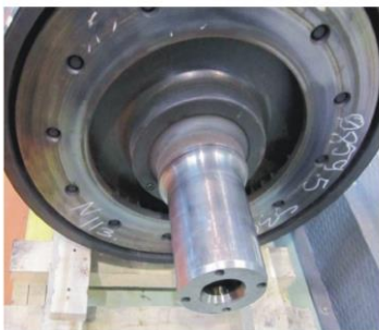
Рисунок 4.231 – Колесная пара без подшипникового блока (а) и с блоком (б)
