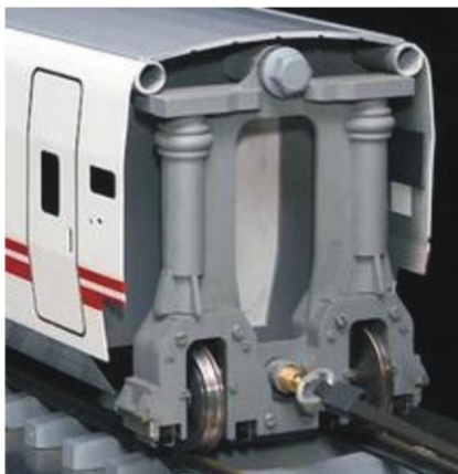
Рисунок 4.194 – К опоре кузова на тележку поезда «Стриж»: а – колесный блок, оборудованный стойками с пневморессорами; б – опора кузова на тележку
