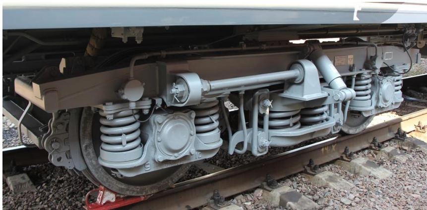
Рисунок 4.143 – Тележка модели 68-875 (общий вид)
