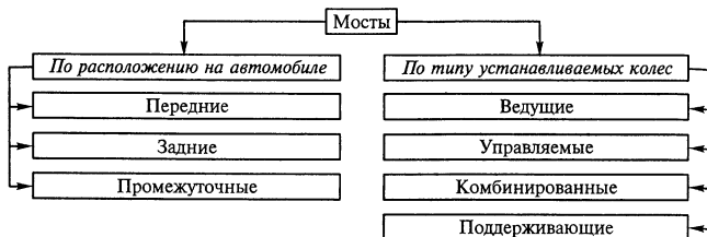
Рисунок 8.1 – Типы мостов автомобилей, классифицированных по различным признакам
