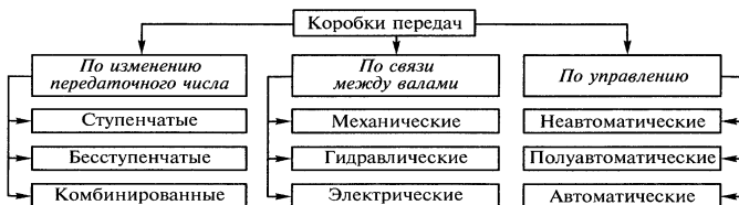
Рисунок 7.1 – Типы коробок передач, классифицированных по различным признакам
