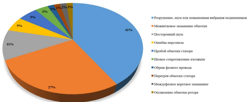
Рисунок 1 – Распределение неисправностей АЭД в процентном соотношении
