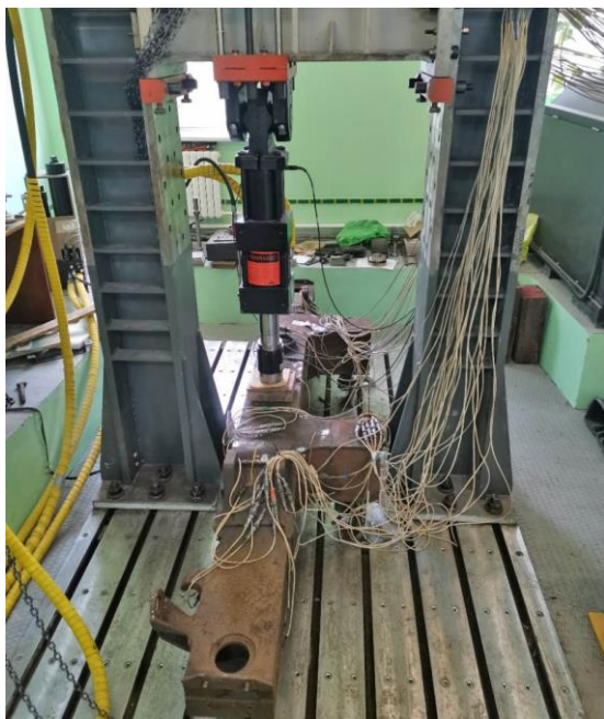
Рисунок 1 – Проведение натуральных испытаний рамы тележки
