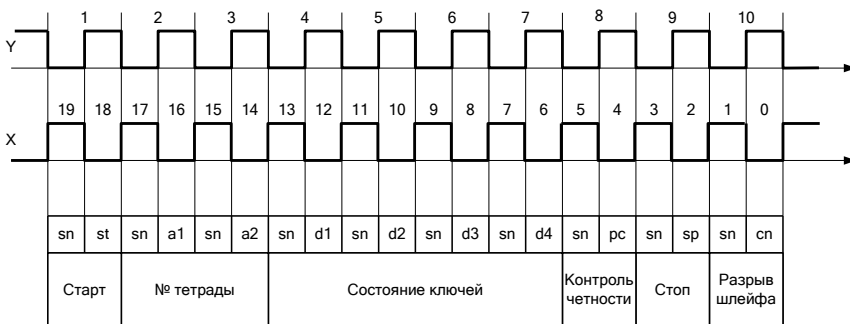
Рисунок 3.7 – Временная диаграмма одного обмена данными
