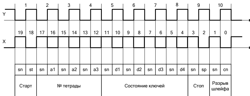
Рисунок 3.9 – Временная диаграмма цикла обмена данными блока ТС-32
