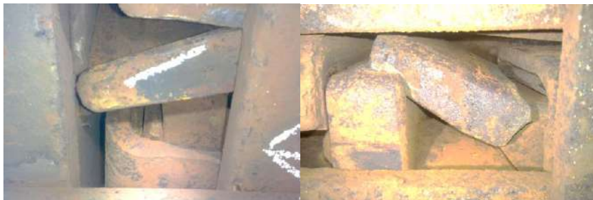
Рисунок 1 – Поперечный излом подвижных пластин
