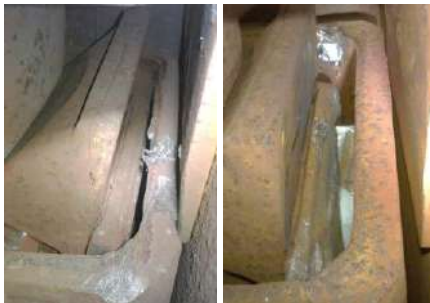
Рисунок 2 – Последствия поперечного излома подвижных пластин
