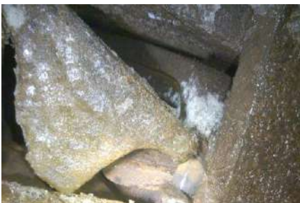
Рисунок 6 – Опасное положение клина фрикционного за пределами корпуса ПА
