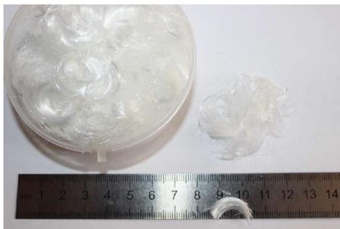
Рисунок 1 – Полипропиленовые волокна длиной 12 мм
