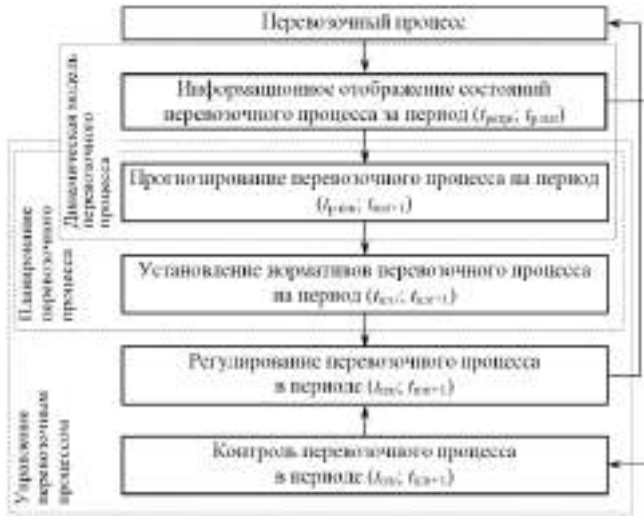
Рисунок 1 – Динамическая модель в структуре управления перевозочным процессом
