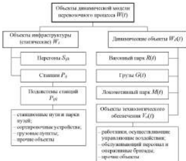
Рисунок 4 – Структурирование объектов динамической модели перевозочного процесса
