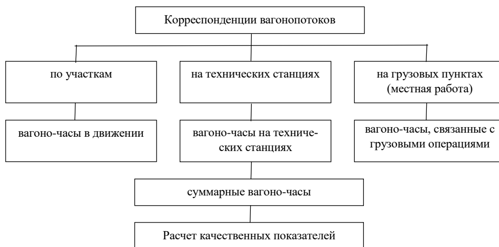
Рисунок 1 – Принципиальная схема определения качественных показателей системы организации движения поездов
