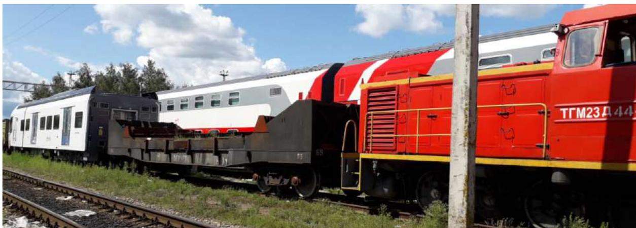
Рисунок 1 – Испытания на соударения
