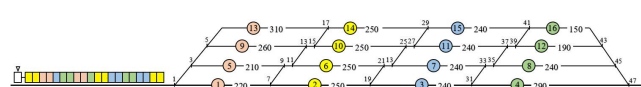
Рисунок 3 – Исходное состояние секционированного сортировочного парка при числе путей N_{п} = 4 и числе секций n_{сек} = 4
