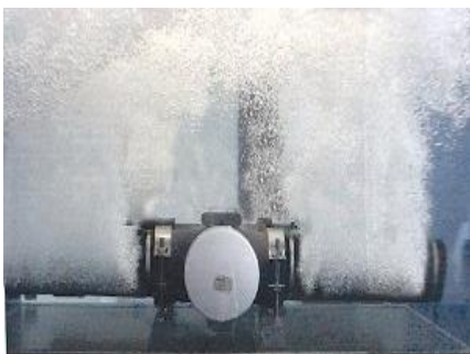
Рисунок 1 – Генерация пузырьков воздуха в воде трубчатым (а) и дисковым (б) пористыми аэраторами, спеченными из губчатого порошка титана марки ТПП-5
