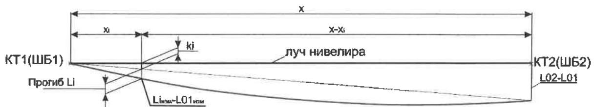
Рисунок 5 – Методика установления прогиба балок машины
