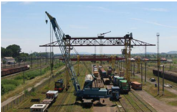
Рисунок 5.1 – Перегрузка штучных грузов в вагоны другой ширины колеи с использованием кранов
