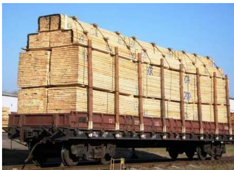
Рисунок 1.12 – Крепление пакетированных пиломатериалов стойками и стяжками
