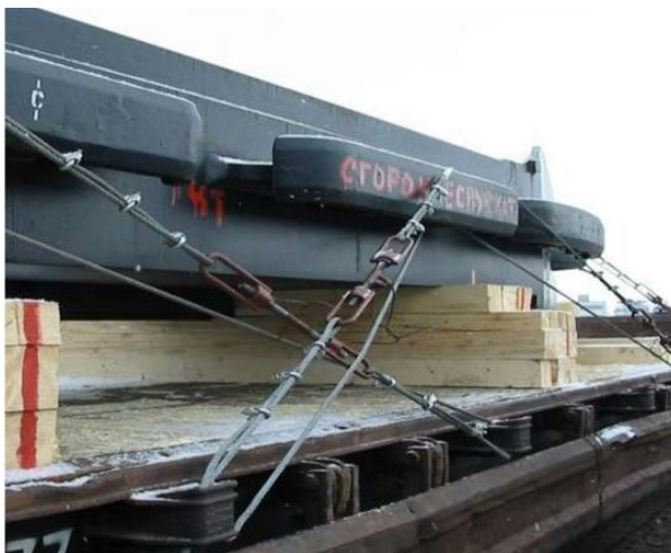
Рисунок 1.14 – Использование многооборотного средства крепления (тросовой растяжки с винтовым натяжным устройством)
