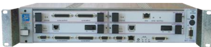
Рисунок 6 – Внешний вид мультиплексора ОЛТ-155Д
