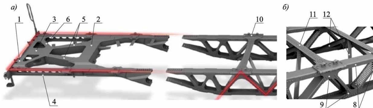
Рисунок 4 – Рама платформы проекта «5L Next»: а – концевая сварная и средняя части; б – фрагмент средней части с поперечными балками рамы [6]
