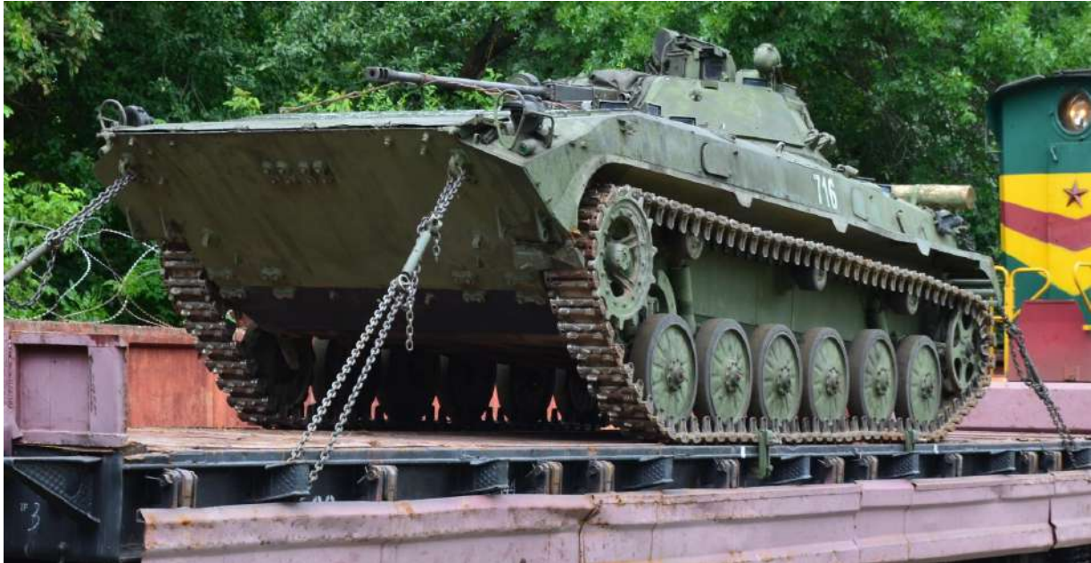
Рисунок 2 – Закрепление гусеничной техники при помощи УМК
