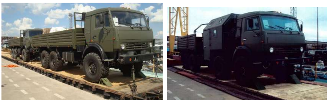
Рисунок 1 – Закрепление колесных машин при помощи УМК ЛК и УМК ТК
