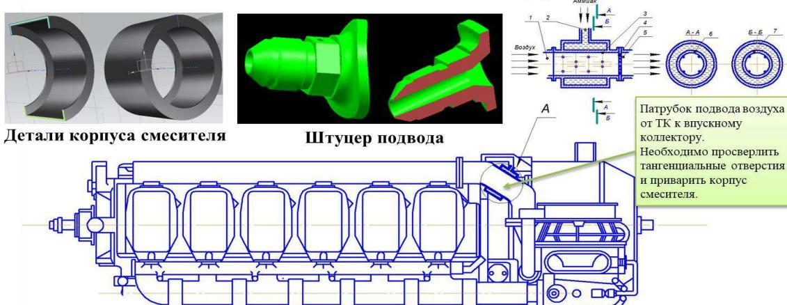
Рисунок 2 – Устройство подачи аммиака на дизеле тепловоза ТЭМ18
