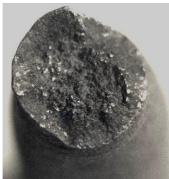
Рисунок 1 – Излом стали вязкий
