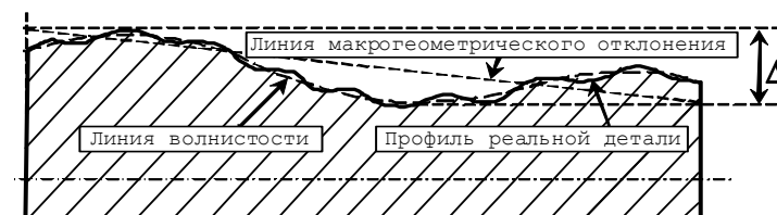
Рисунок 1.1 – Сечение реальной детали плоскостью
