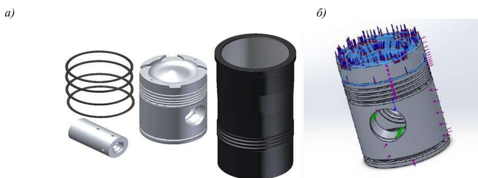
Рисунок 1 – Трехмерные твердотельные модели деталей (а) и макет нагружения модели поршня(б) дизеля K6S310DR
