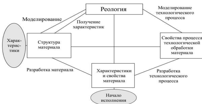
Рисунок 1 – Диаграмма применения реологии для коррелирования характеристик конечного использования и технологической обработки полимеров [3]
