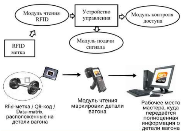
Рисунок 1 – Концепция взаимодействия метки с системой
