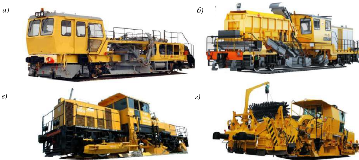
Рисунок 1 – Планировщики и планировщики-распределители балласта: а – ПБ-01; б – РПБ-01; в – СПЗ-5; г – SSP-110SW
